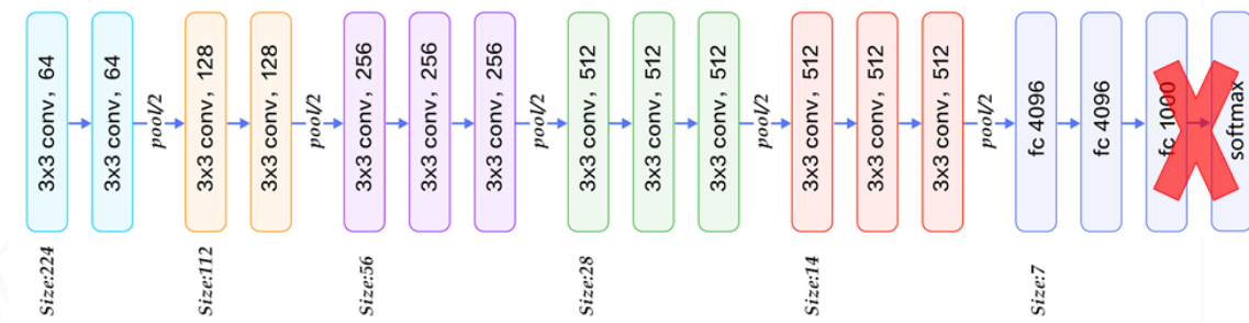
图 3-3 VGG16 网络结构和处理
